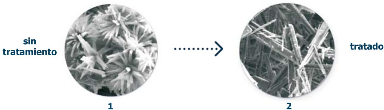
La tecnología de impulsos de Vulcan, patentada, varía a través de procesos naturales de electroforesis la forma de los cristales de calcio y magnesio. La cal, disuelta en el agua tratada con Vulcan, cristaliza en forma de una varilla monocristalina no dañina (fig. 2). Estas varillas de cristales ya no pueden reaccionar entre sí y fluyen con el agua en forma de polvo fino.
